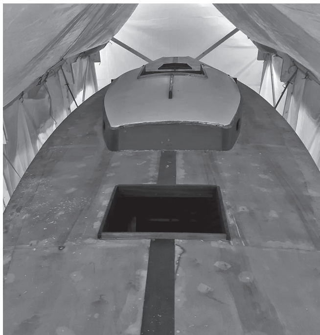
Nytt däck på plats, skarndäck återstår at fräsa in
