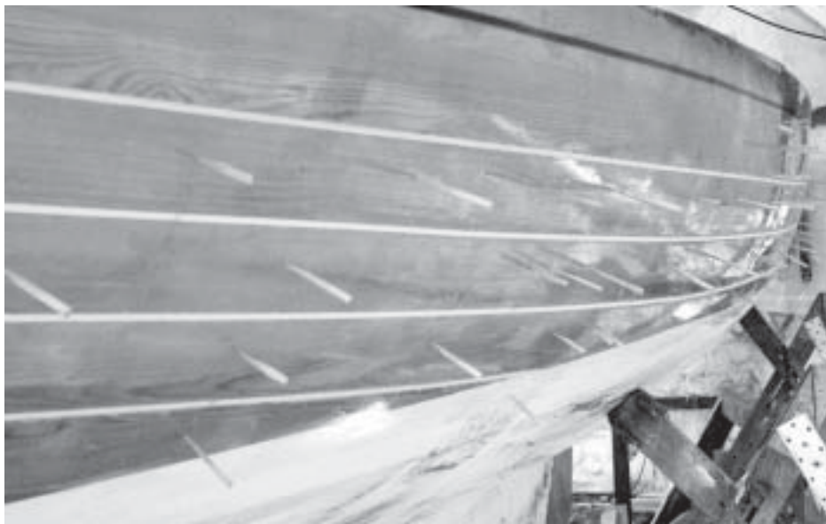
Tonita med pligg! Nåtlisterna kommer så småningom att mörkna så nåtlimingen blir i det närmaste osynlig Foto: Kjell Gustafson
