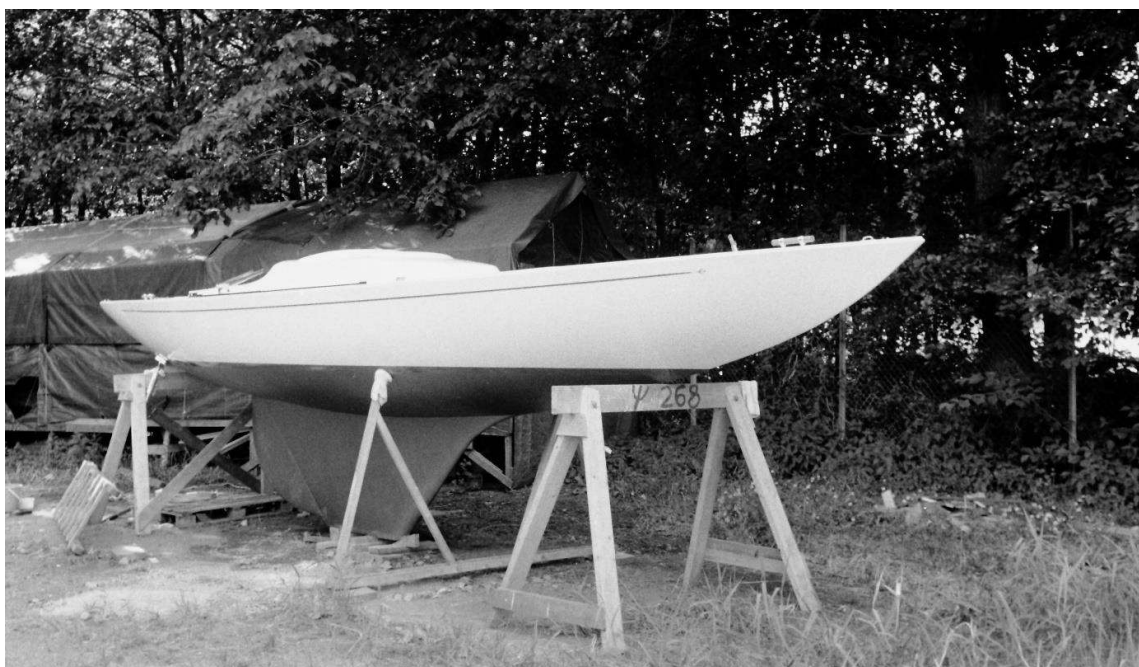
Vattenlinjen hade märkts ut med hjälp av avvägningsinstrument som Martin lånat på sin praktikplats.
