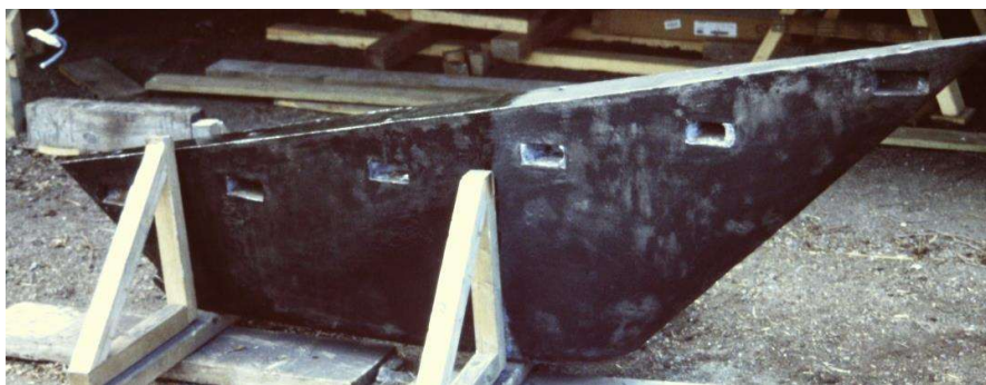
Ovankanten på kölen mallades av för att få kölbultarnas placering
