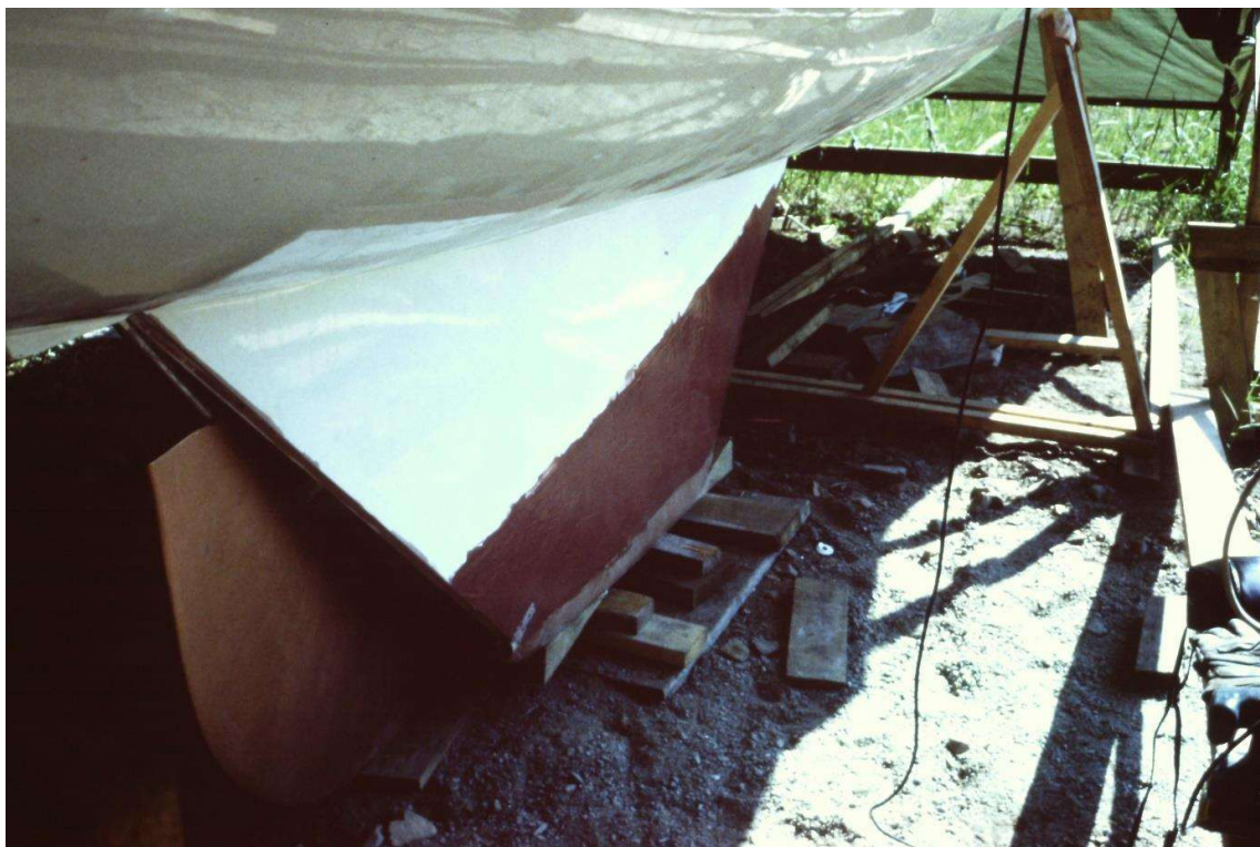
Kölfickorna fylldes med bly och hela kölen spacklades med epoxispackel innan rodret slutmonterades.
