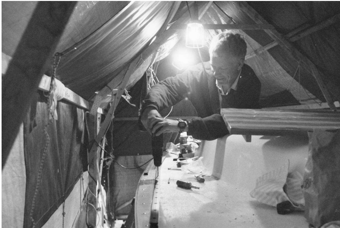
Beslagsmontering pågår. Här gäller det både att ha koll på klassregeln och var grejorna bör sitta för att fungera så bra som möjligt.
