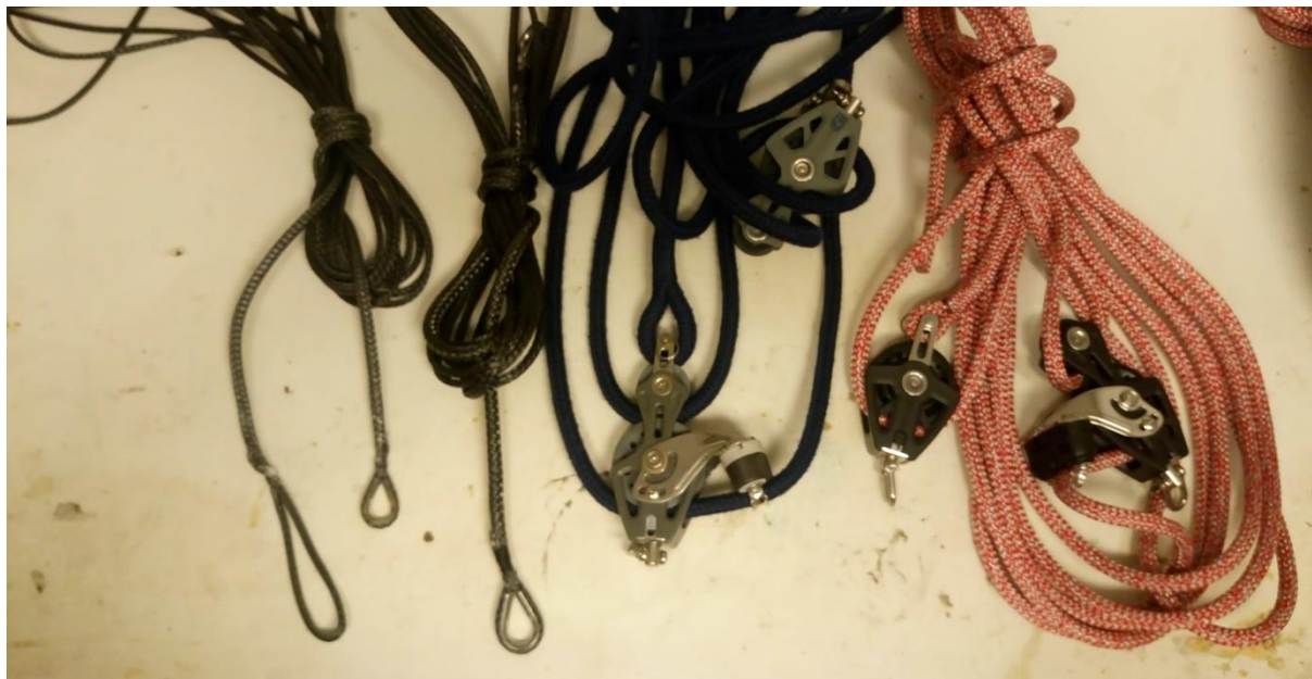
Fr. v. akterstag i 4 mm dyneema, backstag i 5 mm dyneema, kicktalja och backstagstalja i 8 mm flätad polyester.
