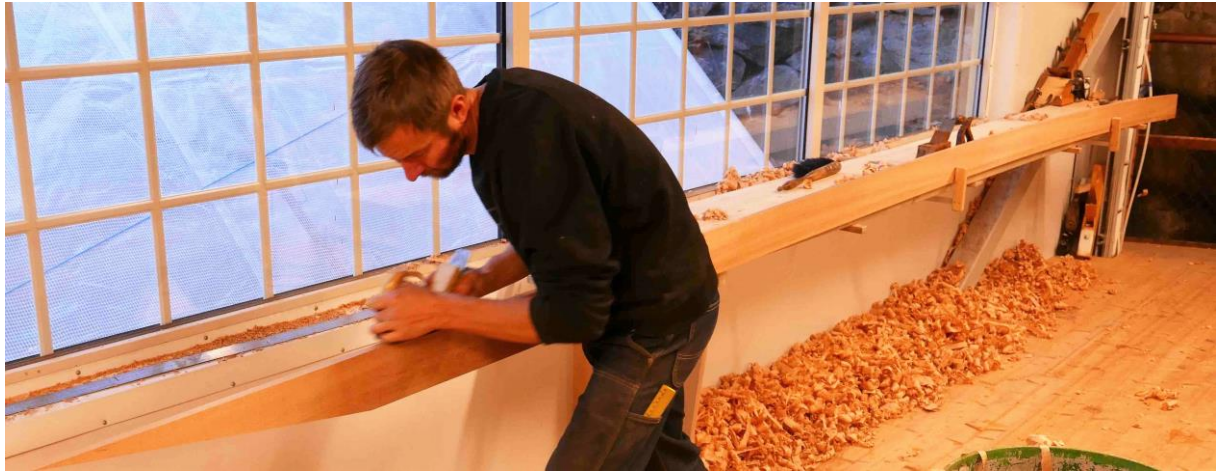
Mattias hyvlar till ett bord för inpassning på den nya Peter Norlin ritade A22:an som just nu håller på att byggas. Foto: Kjell Gustafson den 7 dec 2016
