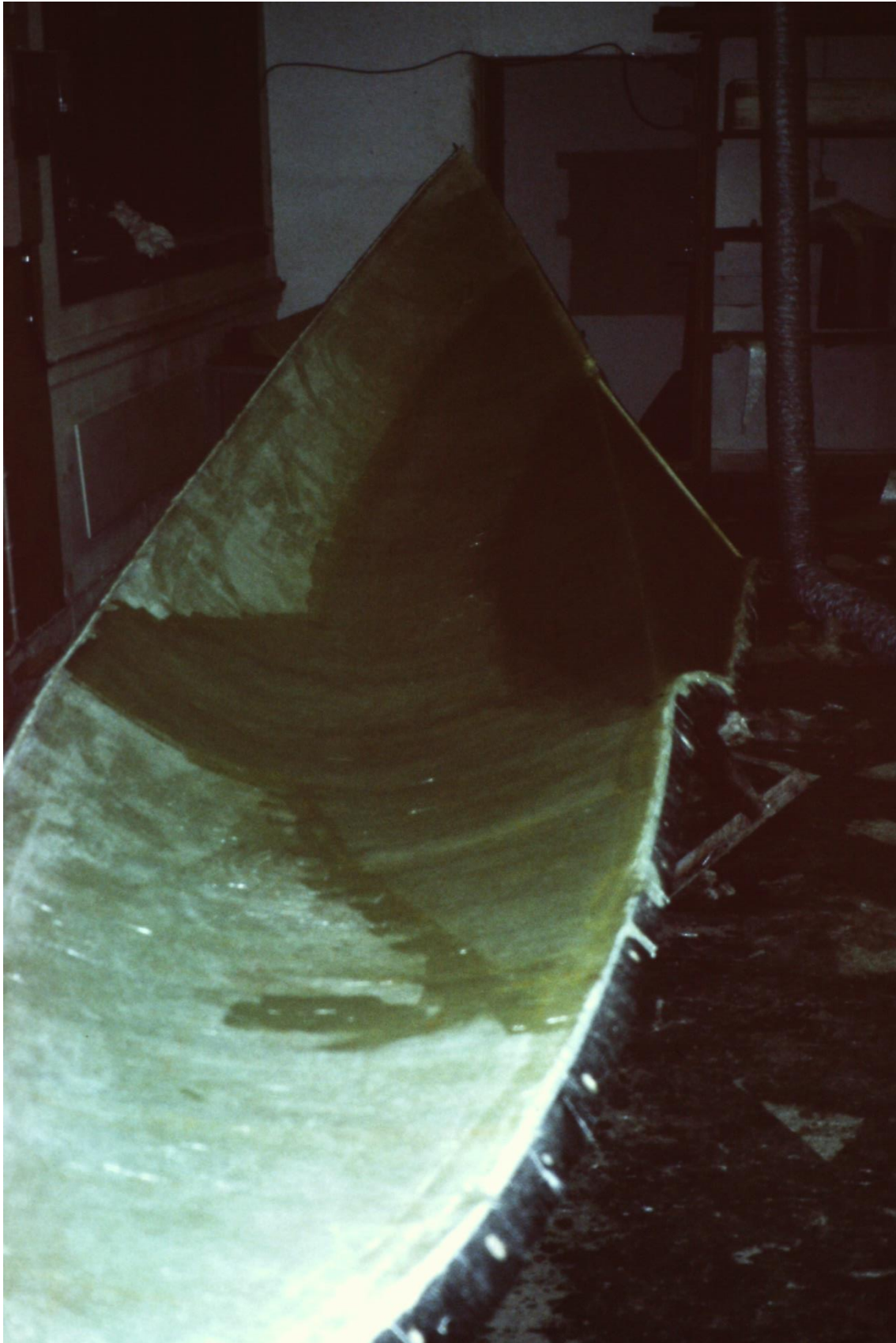
Här syns de extra lagren matta i zon 2 (upp mot röstjärnen för vanten) och zon 3 (kölfickan) väldigt tydligt.
