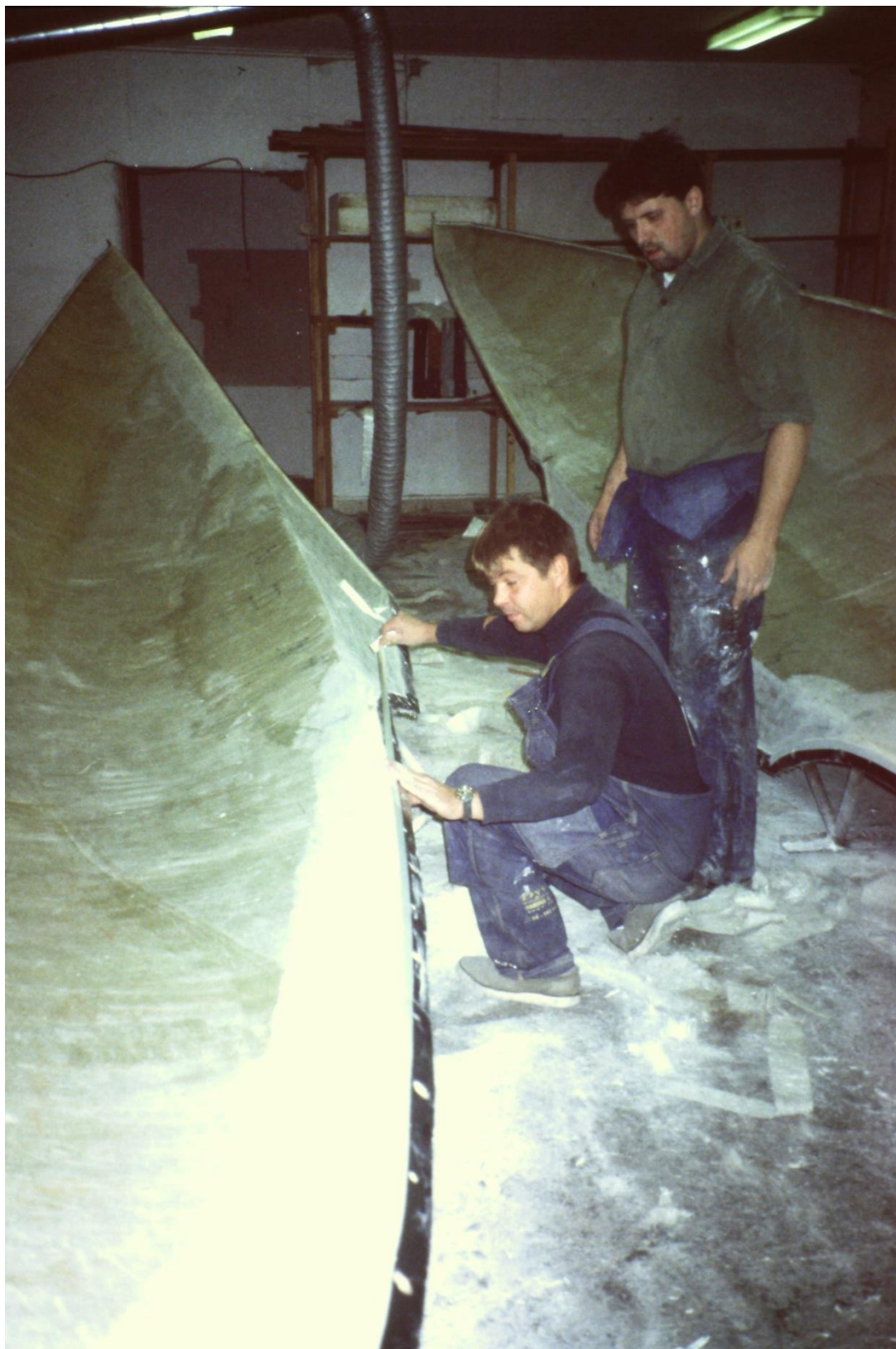
Lasse och Martin förbered hopsättningen av skrovhalvorna.
