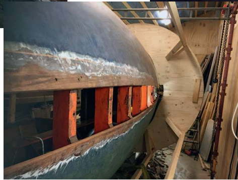
Kölplankan demonterad ända fram till förstäven
