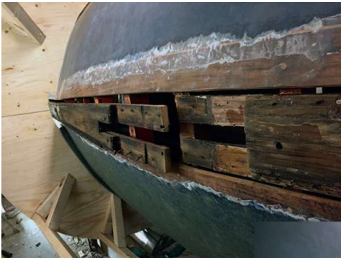
Kölplankan demonterad ända fram till förstäven
