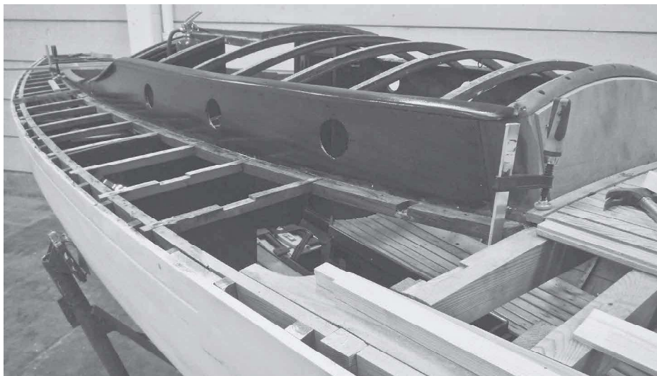
De första lagren med lack har strukits på sidorna av kappen.
