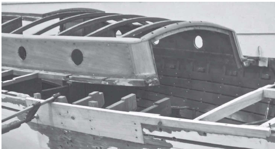
Kappens sidor har fått sig ett par rejäla skrapor och slipningar, del av bordet utbytt.
