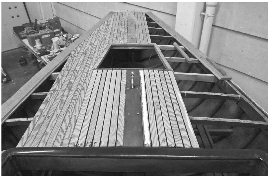
Nåtning akterut, Sikan täcker effektivt kassettbandet med Chopin.
