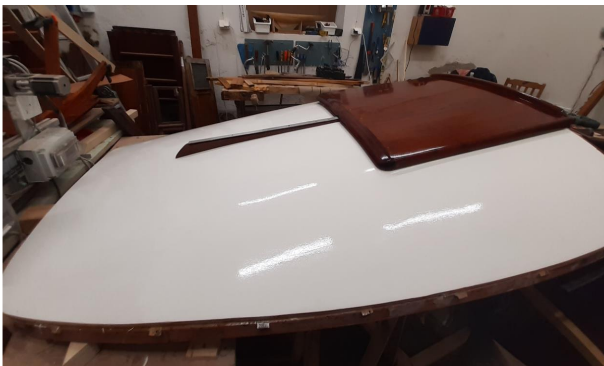
Renoverat rufftak och skjutlucka i verkstaden
